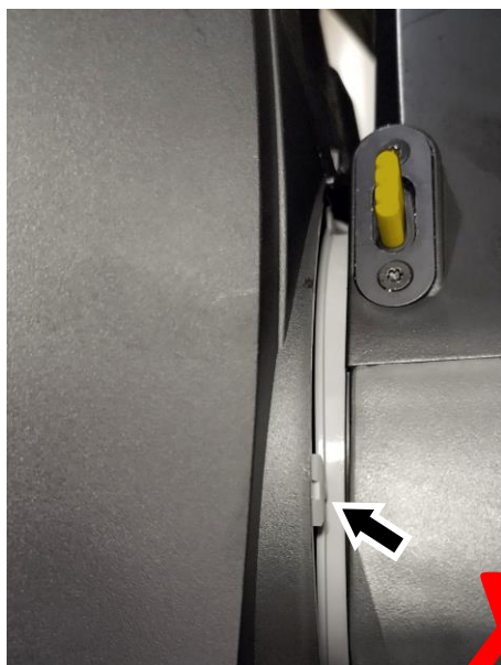
Falsch – Lasche außerhalb der Abdeckung
